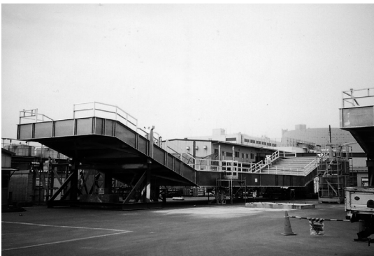
来島大橋下面点検用作業車(アルミ) 本体 W.6300× L.35500× H.3400
