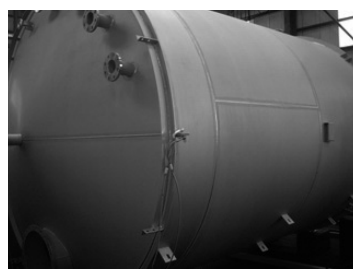
蒸留廃液槽 Ø2500×H4000
