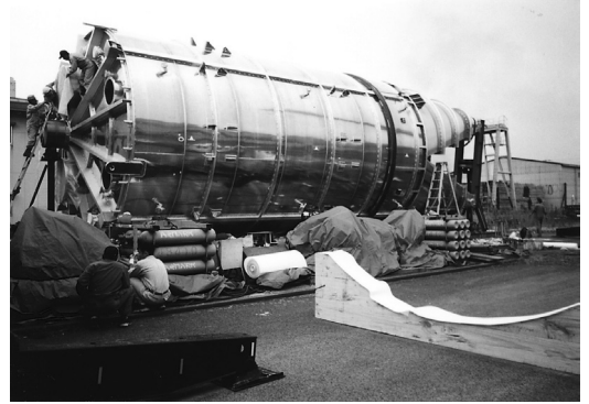
シリコン用350m³ 2室分岐アルミサイロ
