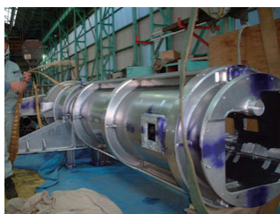
コークス炉溶射装置 (A5083)
