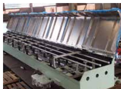
水冷ボックス(全長約8m)
