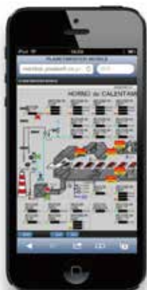
プラントフロー グラフィック表示でプラントを監視
