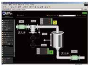
プラントフロー グラフィック表示でプラントを監視
