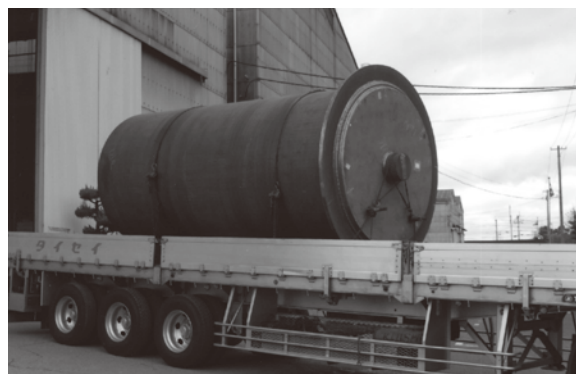
巻き上げドラムφ2700mm(加工前)
