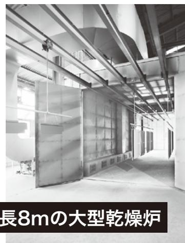
全長8mの大型乾燥炉
