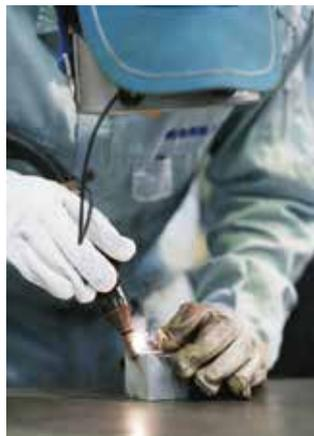
YAGレーザー溶接機
