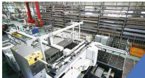
板金自動加工システム(西岡鉄工所設備)
