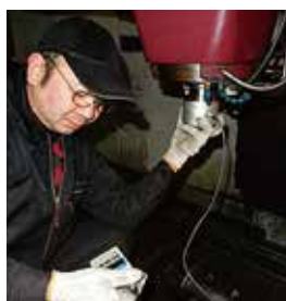
主軸引張り力測定
