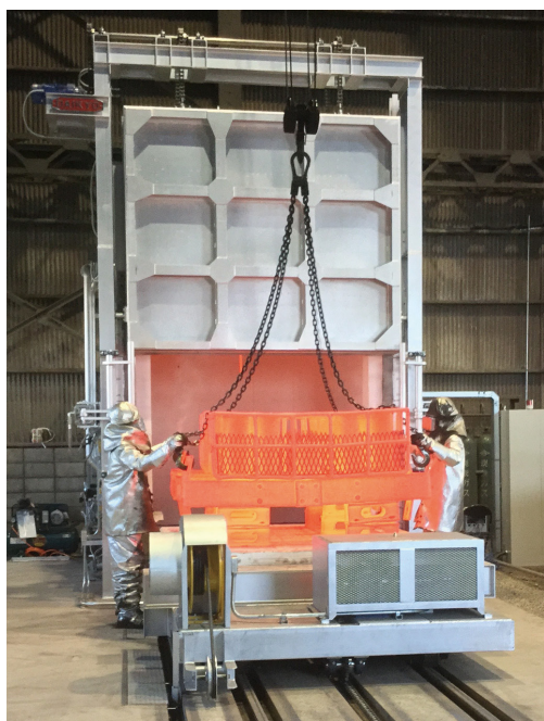
小型炉 (最高加熱温度 950^{\circ}\text{C} )
